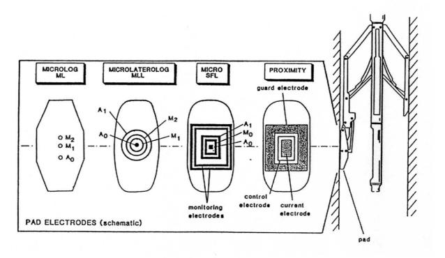
Detectar zonas porosas será posible con las herramientas focalizadas con la condición de que se haya utilizado un lodo suficientemente conductivo. El uso de las sondas no focalizadas solamente dá información cualitativa sobre la existencia del mud cake. En general, la técnica dá también información sobre el estado de la perforación.
