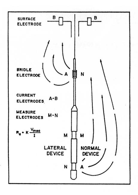
Fig. 3.- Esquema de las sondas normal lateral (Collier. 1.989)
