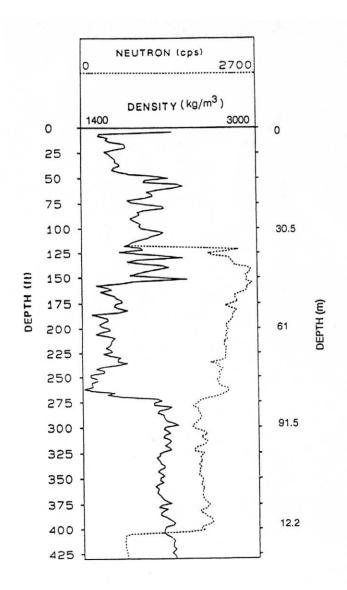
Fig. 9.- Registro de densidad y neutrón-neutrón. (Daniels y Keys).
