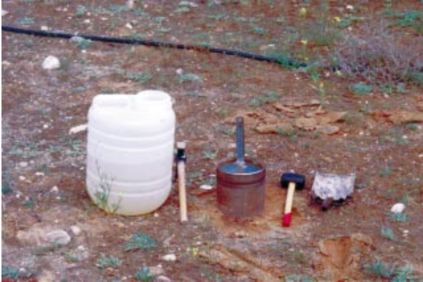
Foto 3.10 Ensayo de infiltración simplificado mediante el empleo de un anillo único. Un periodo de lluvias intenso y prolongado garantizaba que el suelo se encontraba a capacidad de campo y permitió el empleo de un anillo único para la realización de las medidas.
