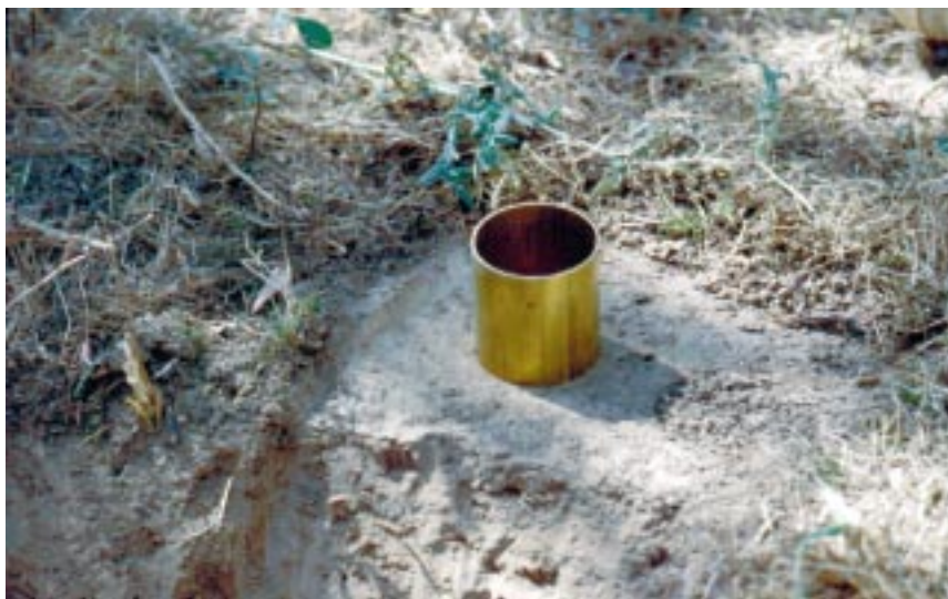
Foto 3.8 La toma de muestras inalteradas permite la obtención de parámetros como la densidad real, la humedad o la porosidad.
