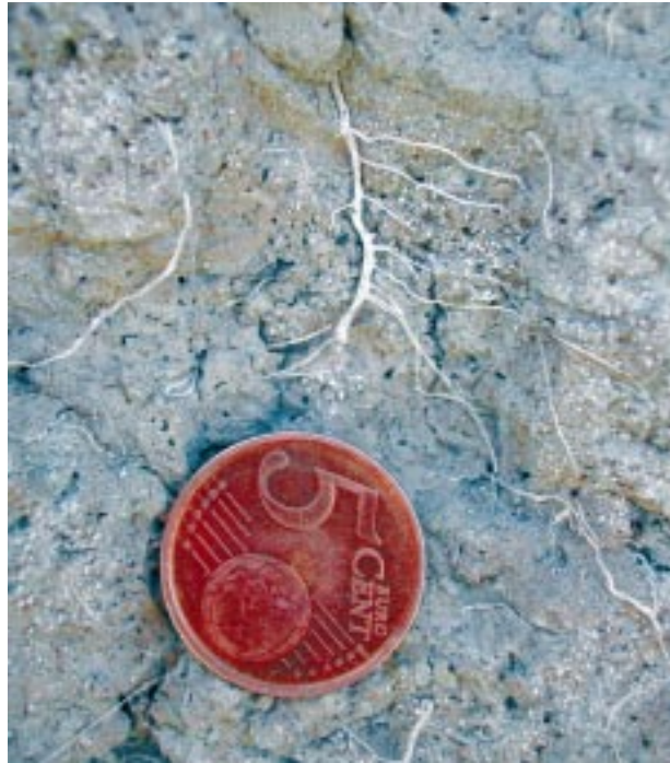
Foto 3.2 La existencia de caminos preferenciales para el flujo del agua modifica sustancialmente la cantidad de agua que puede infiltrarse, pero también los niveles de depuración que pueden conseguirse.
