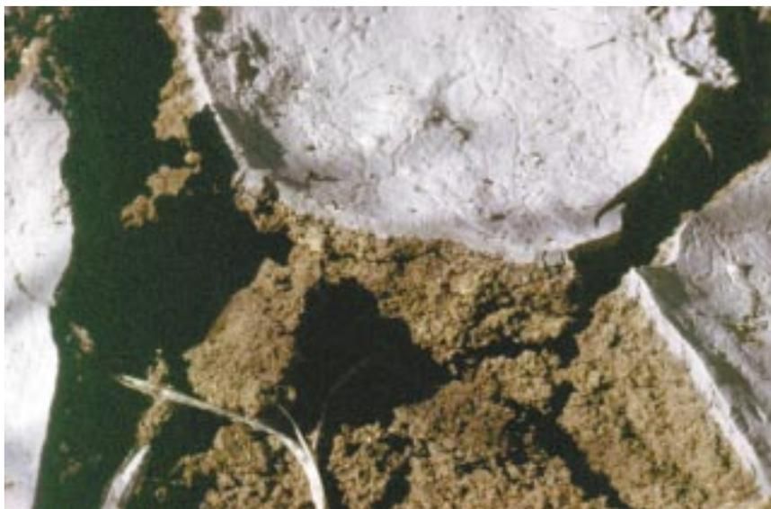
**Foto 5.1** La formación de una costra de colmatación puede llegar a ser extraordinariamente rápida si el agua infiltrada no ha sido convenientemente tratada para eliminar la materia en suspensión antes del vertido.
