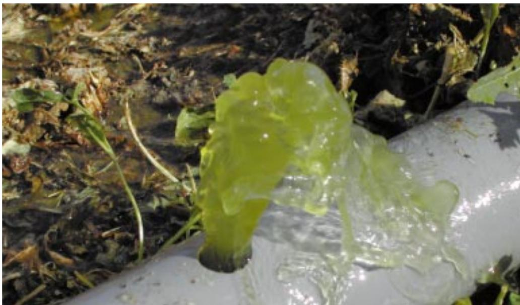
**Foto 5.2** El crecimiento explosivo de algas en las balsas de almacenamiento del agua o en las balsas de infiltración puede dar lugar a problemas imprevistos de colmatación del lecho.
